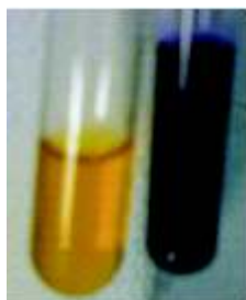
Figura 13. AMINOÁCIDOS Y AMINAS. Ensayo de Ninhidrina +.
