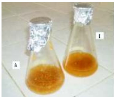
Figura 11. A: Sustancias Solubles en Agua. B: Sustancias Solubles en Etanol 70°G.L.
